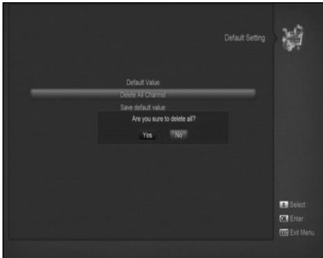
Kada pritisnete taster [OK] u stavci „Brisanje svih kanala”, pojavit će se dijalog i pitati Vas da li želite da potvrdite brisanje svih kanala. Ako izaberete opciju „YES” sví kanali će biti obrisani.
