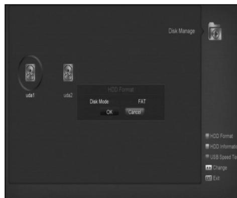
Pritisnite „zelen“ da biste ušli u meni formata HDD kao na slici ispod. Ako želite da formatirate HDD izaberite formate između”FAT“ i „NTFS“. Pritisnite taster „OK“ za potvrdu.
